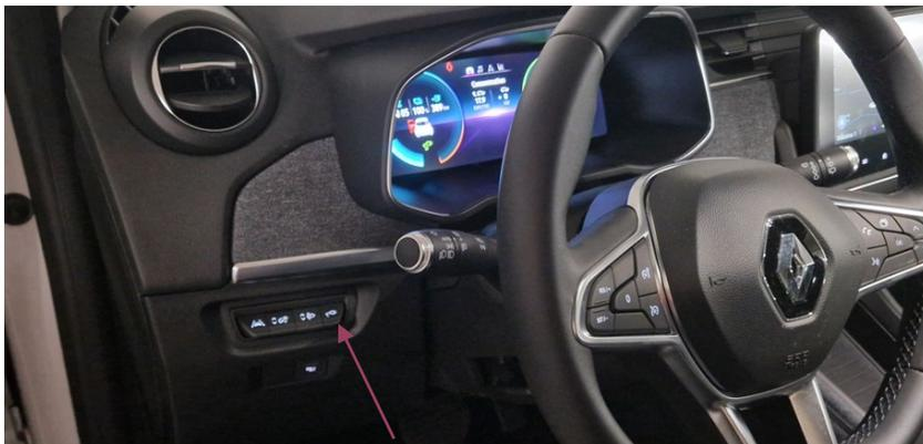
À droite du volant, appuyer sur le bouton indiquant une prise
